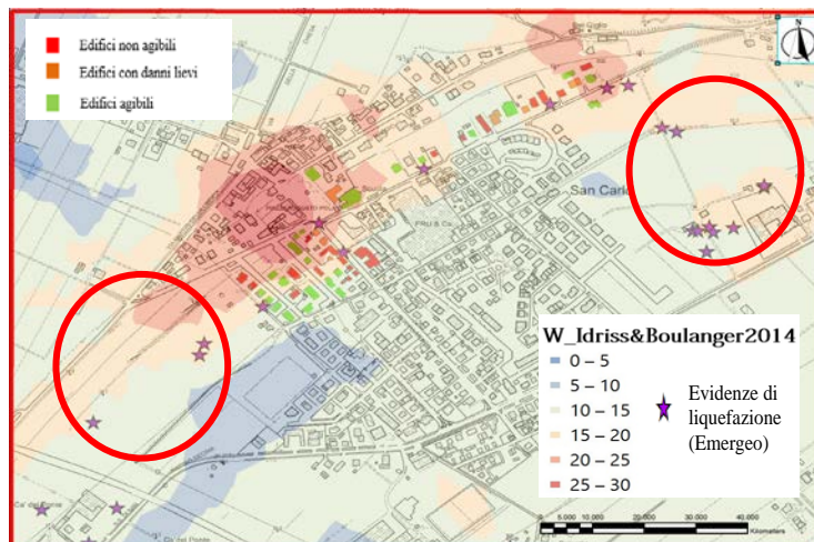
Fig 5. Confronto tra valori dei cedimenti calcolati, effetti di liquefazione osservati al suolo dal gruppo Emergeo dell'INGV e rilievi dei tecnici sugli edifici.
